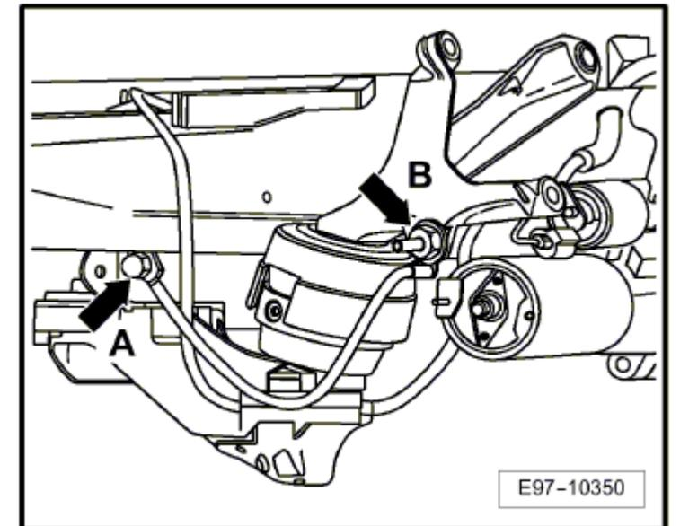
Cinta de masa, batería - carrocería -flecha-
